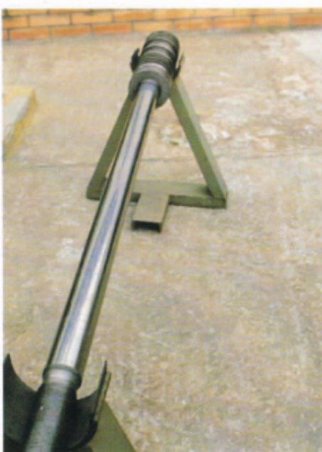
Haste de compressor de gases corrosivos: Carbodur® 124
