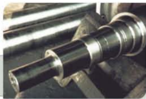
Colos de mancal de cilindro laminador revestidos com material oxi-cerâmico
