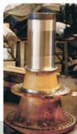
Ponta de eixo de caminhão fora de estrada com os colos de mancais recuperados por aspersão térmica a arco elétrico
