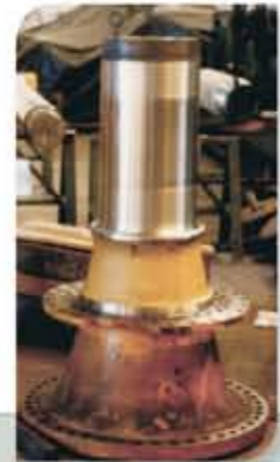
Ponta de eixo de caminhão fora de estrada com os colos de mancais recuperados por aspersão térmica a arco elétrico
