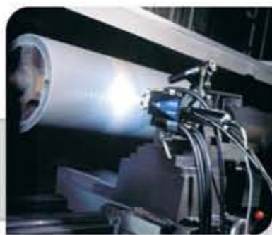
Cilindro de máquina de papel com a mesa revestida por aspersão térmica a arco elétrico
