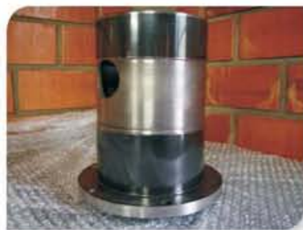
Luva de desgaste com revestimento oxi-cerâmico nos colos de vedação
