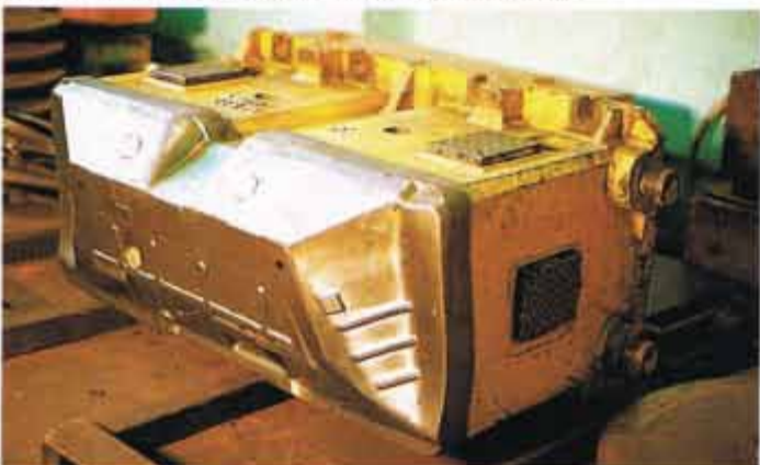
Estampo de repuxo de chapa. Protegido contra efeito de micro-solda e incrustação. Produção 20 vezes superior e a possibilidade de recromar muitas vezes o mesmo estampo reduzem de maneira dramática o custo por peça.
