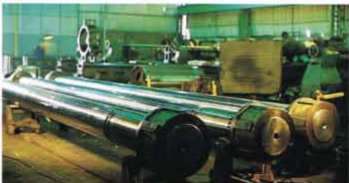
Superfícies duras, de baixo coeficiente de fricção e resistentes à corrosão: Tirantes para injetora de plástico.
