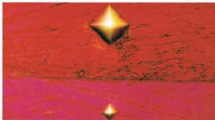
Micrografia da camada de cromo duro mostrando as impressões das determinações de microdureza, feitas com a mesma carga na camada e no material base. 1000X - Nital.
