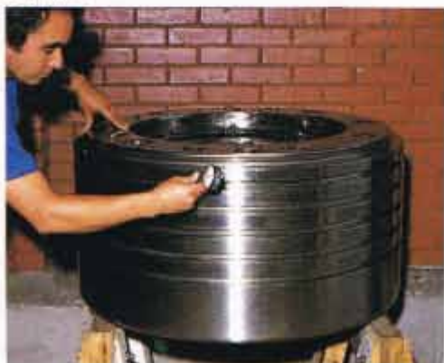
Coroa de pistão para motor de navio: Recuperação dos canais de anéis.
