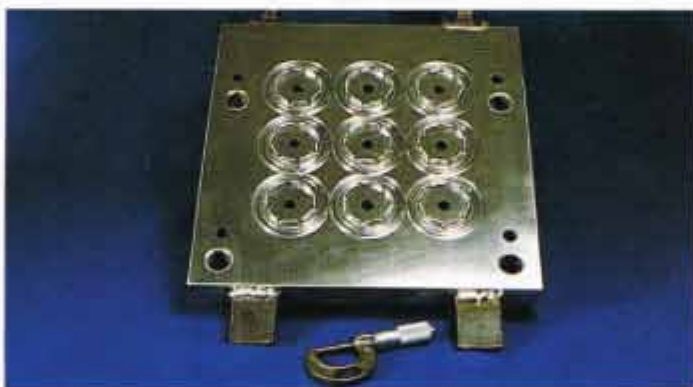
Molde para indústria de plástico. Protegido, contra corrosão e desgaste. A superfície repelente facilita a desmoldagem e confere mais brilho à peça.
