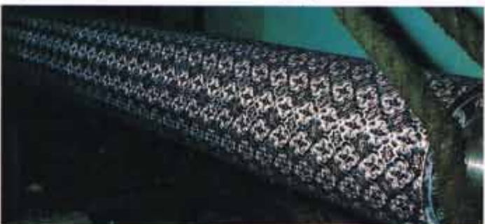
Rolo gravado para estampar vidro. As altas temperaturas do vidro em fusão não danificam a gravação.
